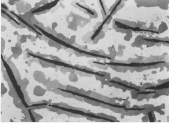
Abb. 7. Schliffbild einer bei 1300° C homogenisierten Schmelzprobe der Zusammensetzung 25 U/30 Pt/45 C (At%), geätzt, Röntgenbefund:  $U_2PtC_2 + UPt_3$  (hell). + C 330fach
